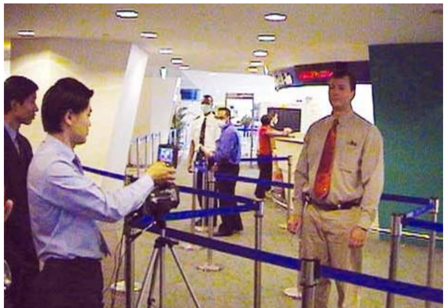
Mise en place d'une caméra infrarouge avec ATC (Automatic Temperature Compensator), pour la détection des températures corporelles élevées.
